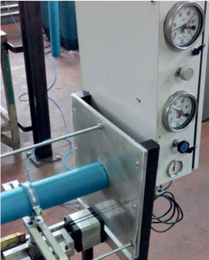
Superación de los test de ensayo de deslizamiento, asegurando el perfecto comportamiento ante dilatación longitudinal como perimetral.
