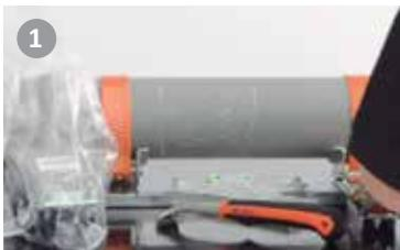
Mida la longitud del accesorio y marque el área de soldadura con un marcador. Rasque la superficie de la tubería cuidadosamente con un raspador.
